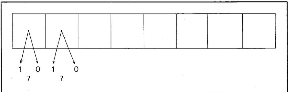
Comme il y a 8 cases, cela donne  $2 \times 2 = \mathbf{256}$  possibilités différentes. On peut schématiser cela de la façon suivante, en mettant **oui** si l'on prend 1, **non** si l'on prend 0.
